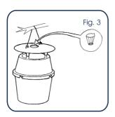
Per completare ed attivare la trappola, inserire il feromone nel cestello e collocarlo nell'apposita apertura del coperchio.
