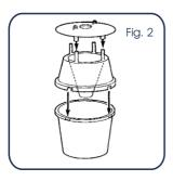
Montare in sequenza i componenti della trappola, facendo attenzione a ruotare ed incastrare la base con l'imbuto sovrastante come mostrato in figura.
